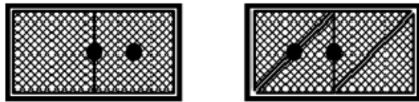
شکل چ-۲- مثالی از آزمون دریچه‌های آدمرو و آب‌گیر دوتایی
