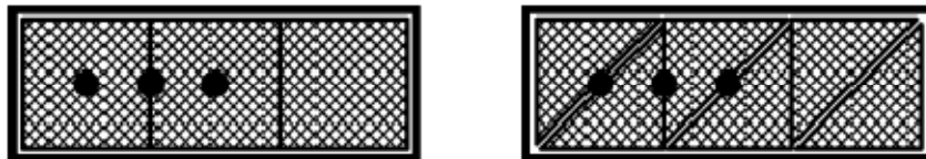
شکل چ-۳- مثالی از آزمون دریچه‌های آدمرو و آب‌گیر سه تایی
